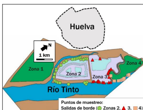
Fig 1. Mapa de localización de la balsa de fosfoyesos sobre suelos de marismas del Río Tinto y puntos de muestreo de las salidas de borde.
